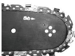
Mutati lama de ghidaj (20) departe de roata de conducere a lantului, astfel încât zalele lantului sa fie plasate în canelura lamei de ghidaj.
