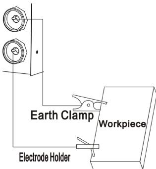
3.4. Vtič za priključitev ročico v vtičnico terminal "+" na sprednji strani in ga zavrtite v smeri urinega kazalca. Nato držite obdelovanca s sponko.
