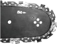
Éloignez la barre de guidage (20) de la roue de la chaîne d'entraînement, afin que les maillons de guidage de la chaîne soient placés dans la rainure de la barre de guidage.
