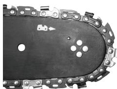
Éloignez la barre de guidage (20) de la roue de la chaîne d'entraînement, afin que les maillons de guidage de la chaîne soient placés dans la rainure de la barre de guidage.
