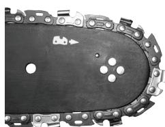
Mova a barra guia (20) para longe da roda motriz de condução, de modo que as ligações de guia da corrente são colocadas na ranhura da barra guia.
