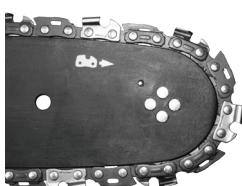
Mutati lama de ghidaj (20) departe de roata de conducere a lantului, astfel încât zalele lantului să fie plasate în canelura lamei de ghidaj.
