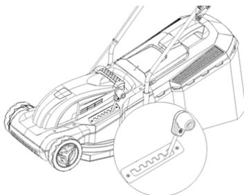
**3.4. Verificați ca șurubul care deține lama este bine. Cheie Șurub cu cap pentru comutator**
