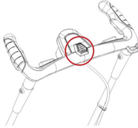
3.7. Električna kosilica se isključuje spuštanjem ručice (1) na prekidaču i pokretač čekanja da se nož prestane vrteti!
