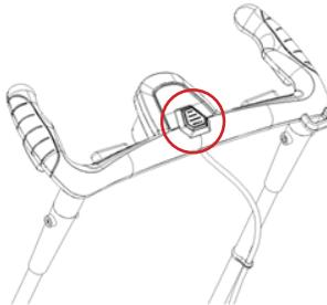
3.7. Masina de tuns iarba electrica afara de rularea maneta (1) de pe comutator și nu așteaptă neapărat pentru cuțit de a înceta să se rotească!
