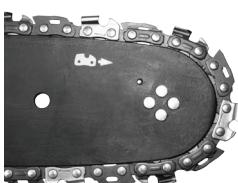
Mutati lama de ghidaj (20) departe de roata de conducere a lantului, astfel încât zalele lantului sa fie plasate în canelura lamei de ghidaj.
